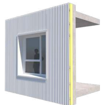
Bardage en tôle ondulée
